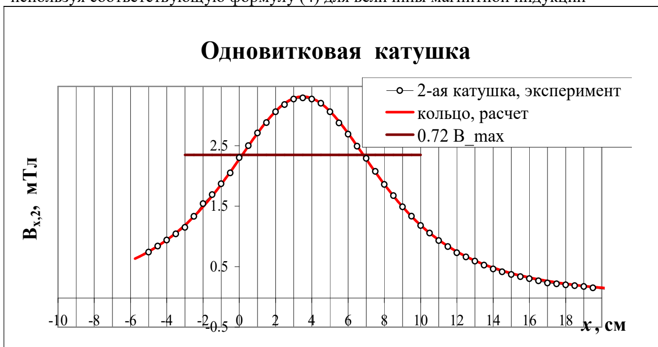
Рис. 6. Измеренная и рассчитанная магнитная индукция B_{x,2} вдоль оси тонкой катушки (кольца с током)
