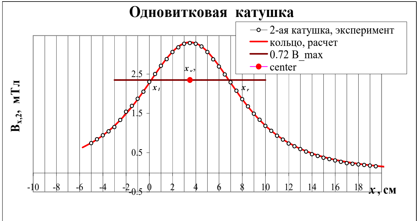
Рис. П2. Определение параметров катушки из сравнения измеренной и рассчитанной магнитной индукции B_{x,2} вдоль оси тонкой катушки (кольца с током)
